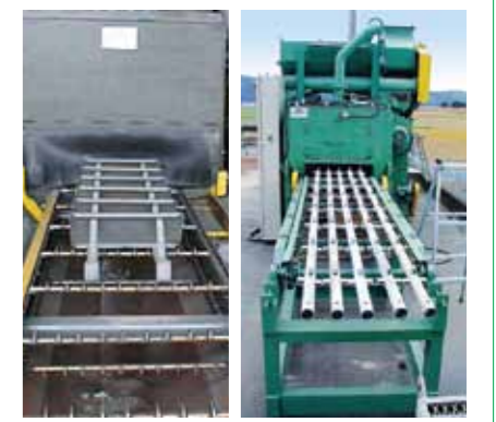
↑階段 プラスト出口 ↑支柱 プラスト入口
